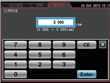
● 显示区带转速设置画面, 并以黑色字符显示当前的设定转速。 |
